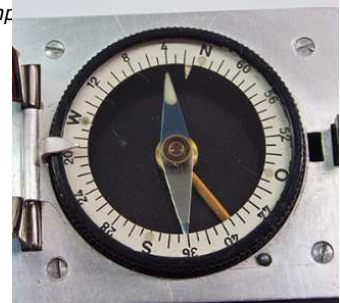
Skala des Touristenkompasses mit Stabilisationsring
