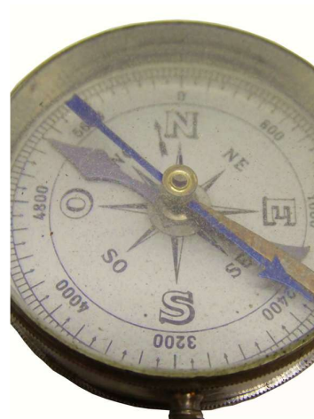
64-00 Strich Skala Deklinationskorrektur bei 250 Strich West
