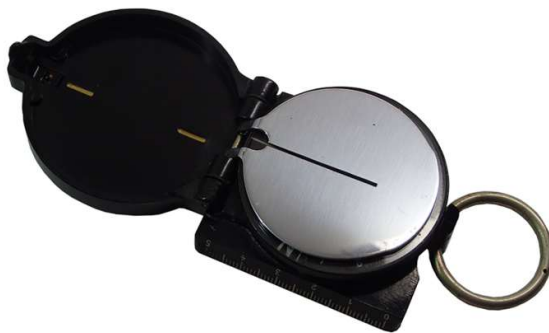
MK II F mit offenem Deckel und geschlossenem Spiegel man beachte den Visierschlitz
