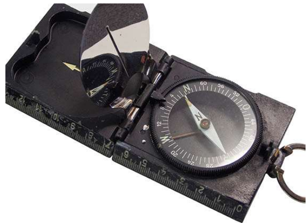
Marschkompass aus Elektron aus dem Jahre 1940
