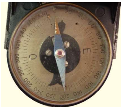
CRC Modèle 1922 400 gon Skala rechtsdrehend
