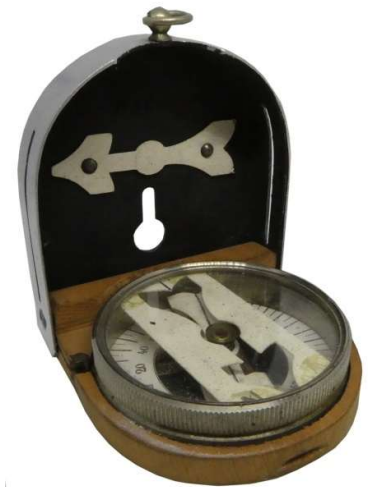
Diopterbussole aus dem Jahre 1905 nachleuchtend durch Balmainflüssigkeit
