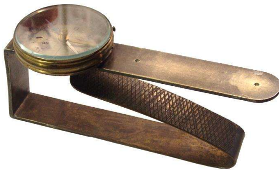
gut erkennbarer Klammermechanismus
