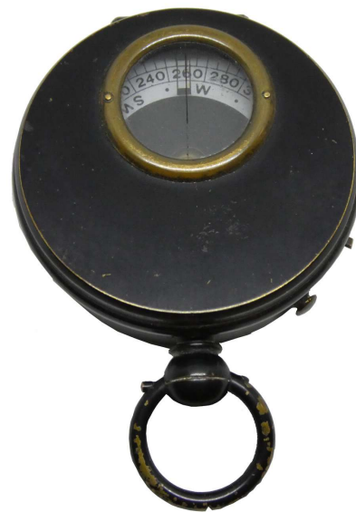
Ablesemöglichkeit bei geschlossenem Deckel
