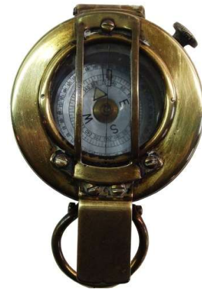
Ablesung bei geschlossenem Deckel
