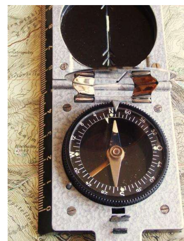
Deklinationsskorrektur manuell angepasst
