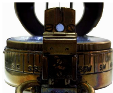
Anvisieren über Prisma und Visierstrich
