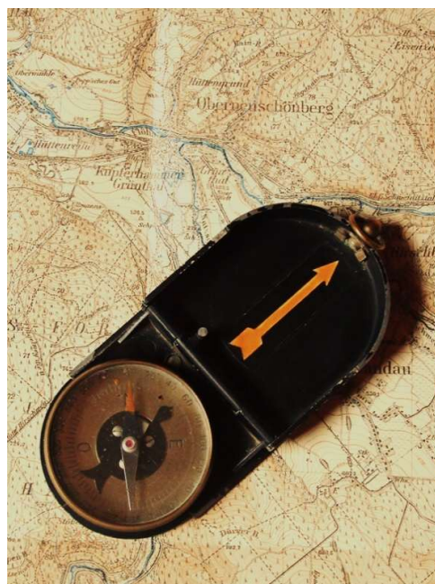
Ermitteln der Marschrichtung mittels dem Modèle 1922 auf einer Meßtischkarte 1:25.000
