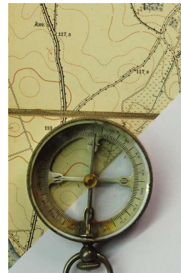
K. S. Stockert Kartenkompass mit Ermittlung der Marschrichtung zum Ziel
