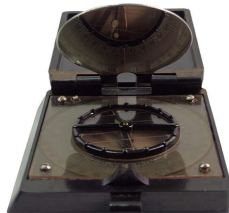
Anvisieren eines Zieles über Kimme und Korn, Ablesung mittels Spiegel
