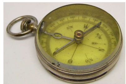
Kartenkompass mit einer Remontoirarretierung
