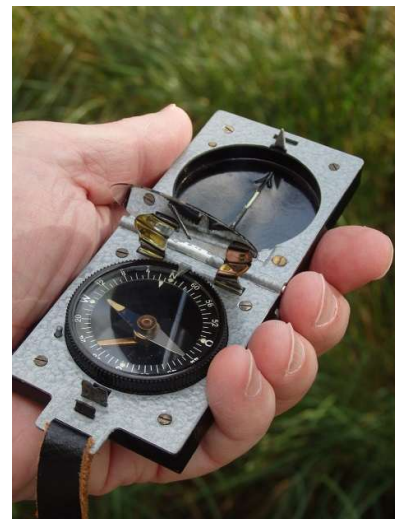
MK II aus den 1940er Jahren mit Ablesung an der Kompassnadel
