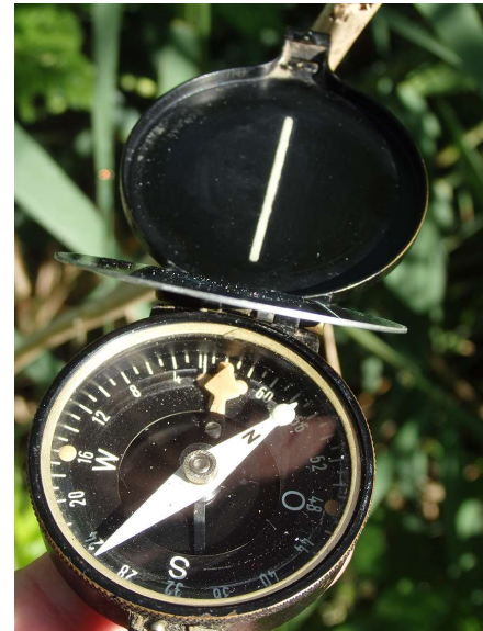
oben: Marschkompass der Reichswehr 1928 aus Kriegskunst in Wort und Bild, Heft 8,1928 rechts Marschkompass der Wehrmacht nach dem Jahr 1936 mit einer Wirbelstromdämpfung (Patent Busch)
