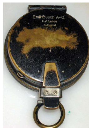
brüniertes Gehäuse mit gerändeltem Rand
