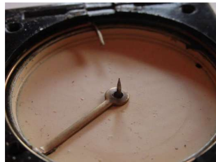
Gehäuseboden mit Pinne und verstellbarem Deklinationsstift
