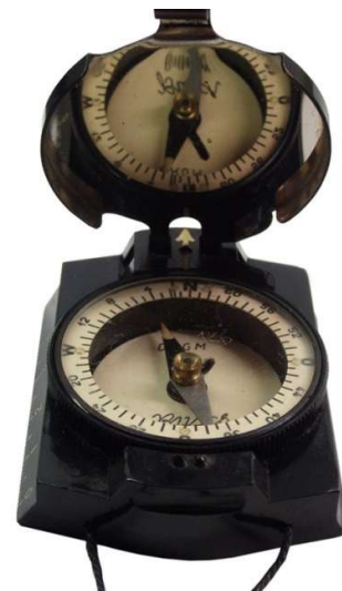
Verwendung eines Spiegels für eine bessere Orientierung
