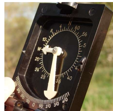
Kippen des Deckels und Ablesen des Steigung
