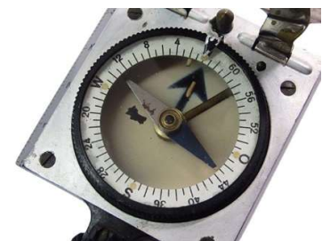
Skala 64-00 Strich linksdrehend mit nachtleuchtendem Marschrichtungspfeil
