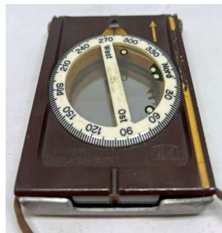
Kompassgehäuse aus Bakelit und einem Metalldeckel
