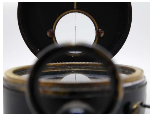
Der Daumenring mit einer Kerbe als Peilhilfe
