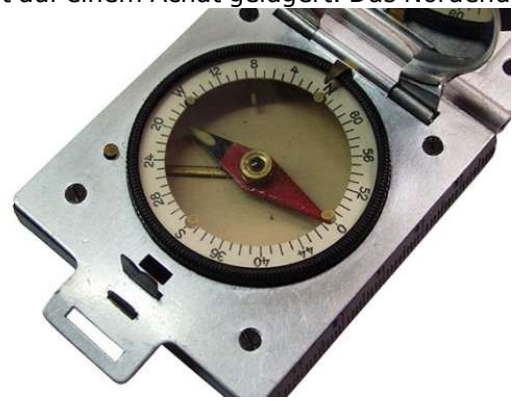
Skala linksdrehend in 64-00 Strich
