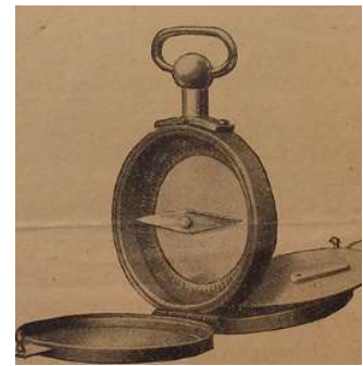
Modell Nr 2 ohne Deklinationskorrektur aus den 1930er Jahren
