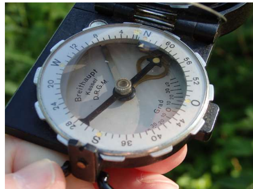
Ablezen des Azimuts
