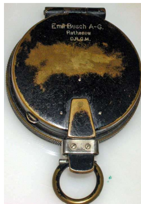
brüniertes Gehäuse mit gerändeltem Rand
