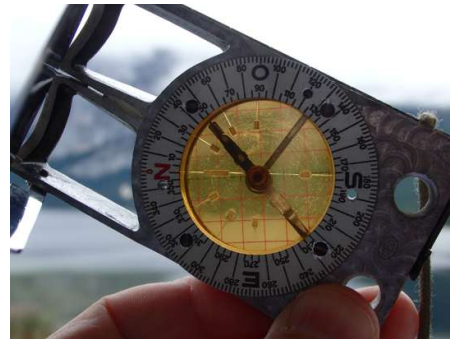
Winterer Bussole bei Messen von Höhenwinkeln
