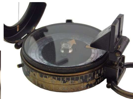
Prisma zur Ablesung der Skala
