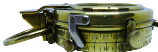
Arretierhebel des Kompassrose
