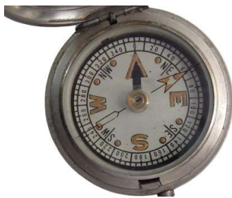
Skala mit Marschrichtungspfeil
