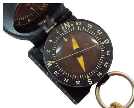
Skala 64-00 Strich linksdrehend Deklinationskorrektur bei 180 Strich WEST
