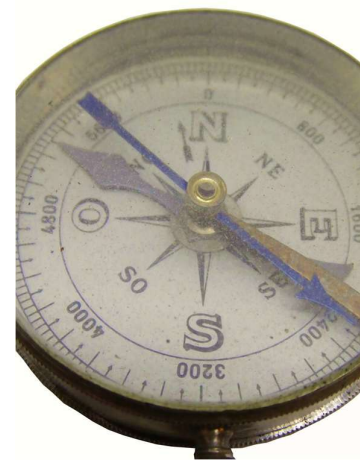
64-00 Strich Skala Deklinationskorrektur bei 250 Strich West
