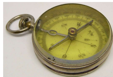
Kartenkompass mit einer Remontoirarretierung
