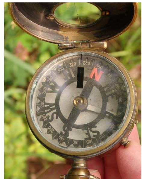
Skala 360 Grad rechtsdrehend „Skeleton Dial“
