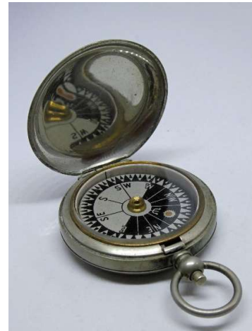
Skala nach Singer Patent mit radioaktiver Markierung
