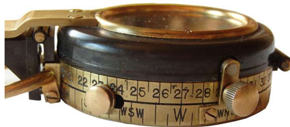
Seitliche Skala mit Arretiermechanismus der Perlmutscheibe
