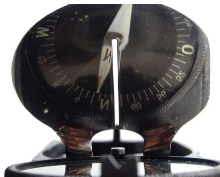
Anvisieren über den Peilschlitze
