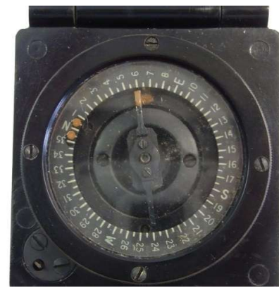
Skala 360 Grad rechtsdrehend
