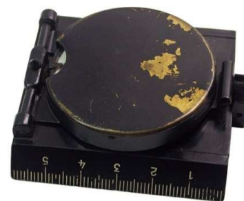
Metallspiegel mit Anlegekante
