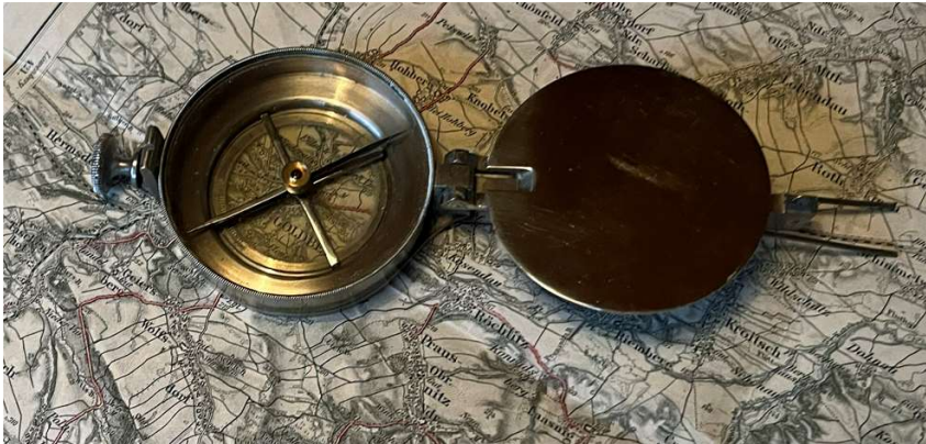
Marschrichtung aus der Karte ermitteln und Ablesen der Marschrichtung an der seitlichen Ablesemarke
