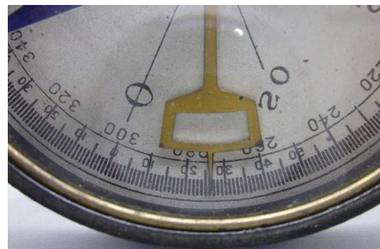
Neigungsmesser in die Skala integriert
