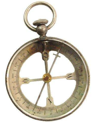
K. S. Stockert ca. 1915 Remontoirarretierung und Balkennadel
