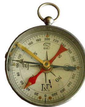
mit rotem Marschrichtungspfeil und Leuchtmarkierungen radioaktiv
