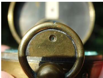
In die Öse ist die Kimme als Lochdiopter eingefügt
