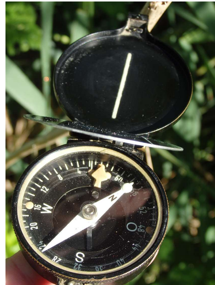
oben: Marschkompass der Reichswehr 1928 aus Kriegskunst in Wort und Bild, Heft 8,1928 rechts Marschkompass der Wehrmacht nach dem Jahr 1936 mit einer Wirbelstromdämpfung (Patent Busch)
