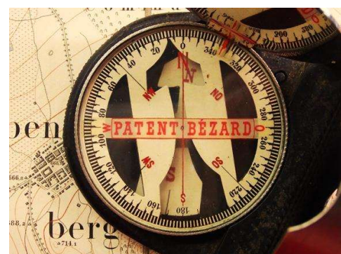
Skala 360 Grad linksdrehend
