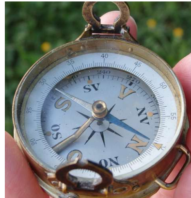
Skala mit Visiereinrichtung
