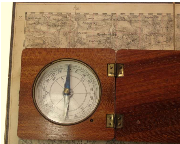
Morin Kompass im Holzgehäuse mit Deklinationskorrektur von 22 Grad West, ca. 1885, Frankreich auf Meßtischblatt von 1879
