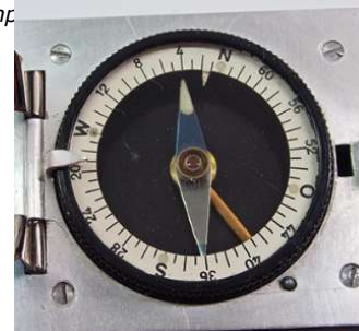
Skala des Touristenkompasses mit Stabilisationsring
