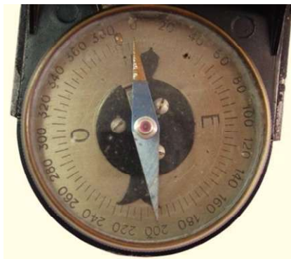
CRC Modéle 1922 400 gon Skala rechtsdrehend
