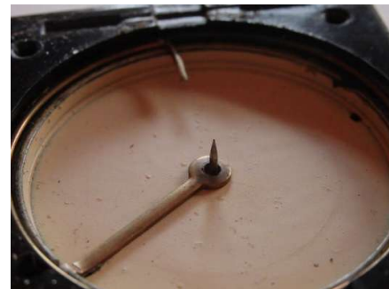
Gehäuseboden mit Pinne und verstellbarem Deklinationsstift
