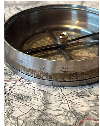
Marschrichtung aus der Karte ermitteln und Ablesen der Marschrichtung an der seitlichen Ablesemarke
