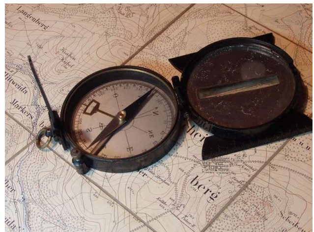
Anlegen der Anlegekanten in der Landkarte um Entfernungen aus der Karte abzulesen
