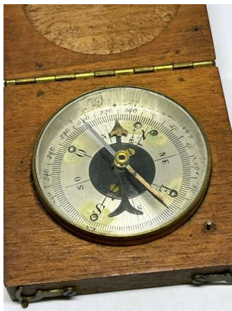
Skala mit radioaktiven Markierungen
