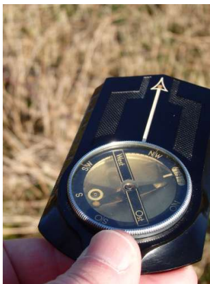
Ermitteln der Marschrichtung und „Senkrechtstellen“ des Falke Marschkompasses
