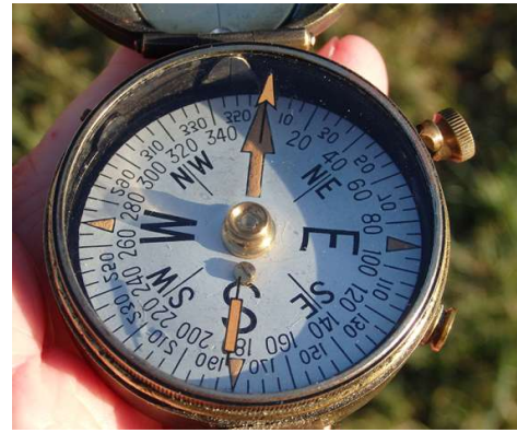
Skala mit radiumhaltigem Leuchtmittel
