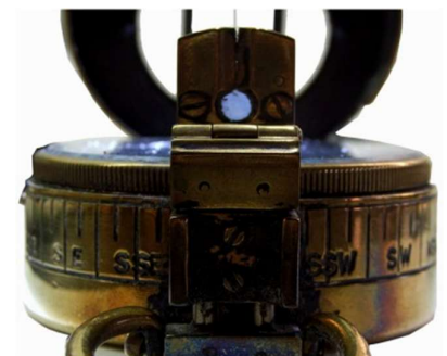
Anvisieren über Prisma und Visierstrich
