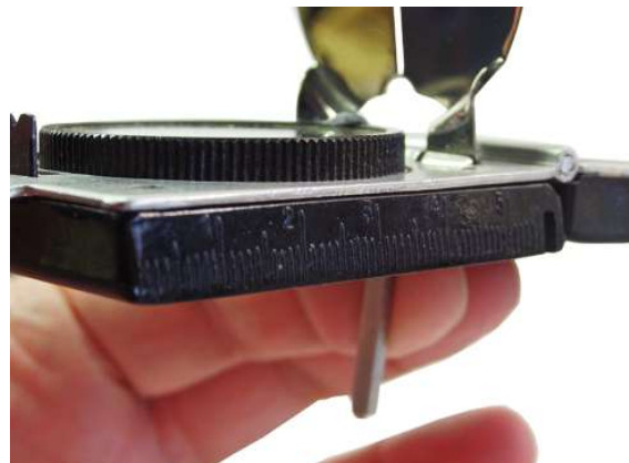
Haltemechanismus des Marschkompasses I Patent 1936 – D.R.P.
