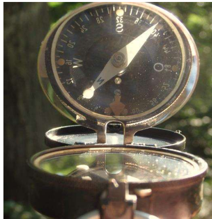
Ablesung und Anvisieren eines Ziels
