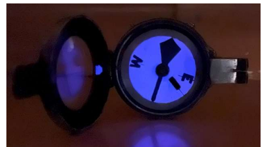
Nachtauglich nach Bestrahlen mit einer hochenergetischen Lampe
