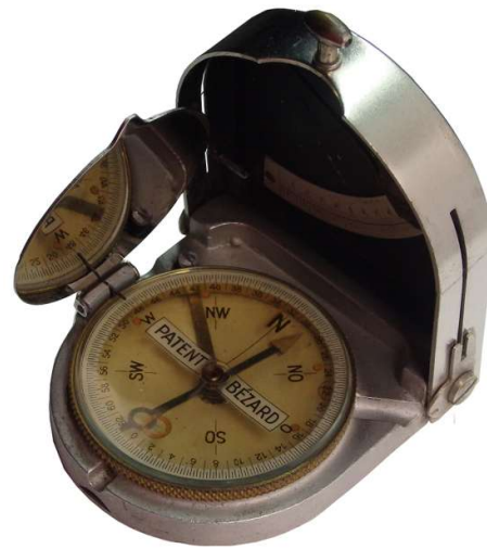
UBK – Patent-Bézard mit 32-00 Strich versetzter Skala
