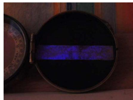
Orientierungsstrich nachleuchtend für das Anpeilen der Marschrichtung
