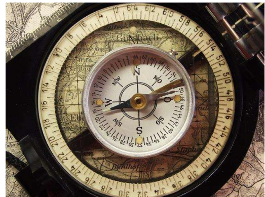
Skala 64-00 Strich rechts- und linksdrehend
