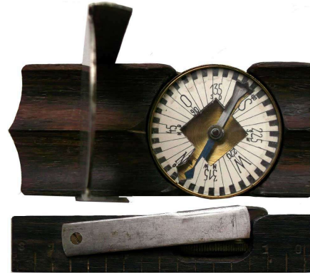
Urmmodell der Winterer Bussole, Ablesung ähnlich dem Bézard-Kompass „Großes Armee Modell 1910“
