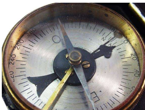
Gaumont Skala Modéle 1922 400 gon Skala
