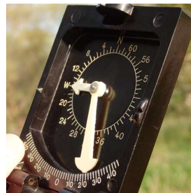
Kippen des Deckels und Ablesen des Steigung
