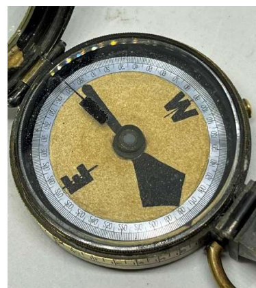
Skala für die Ablesung in 360 Grad
