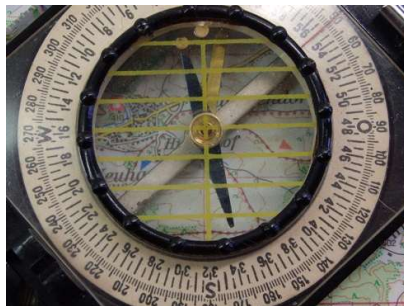
Kührt II mit Steinlagerung der Nadel
