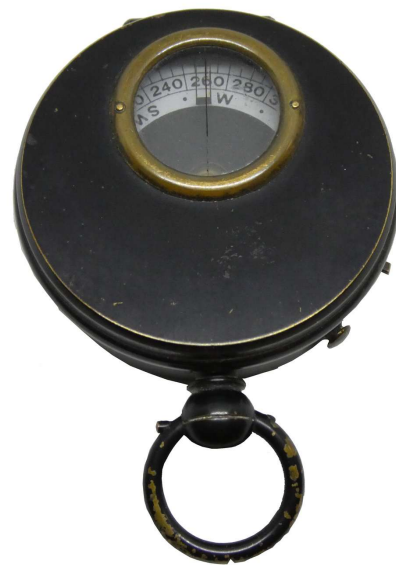
Ablesemöglichkeit bei geschlossenem Deckel
