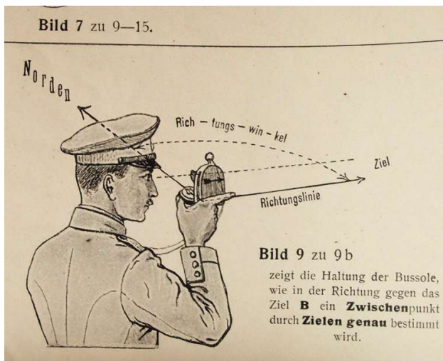
Anschauliche Darstellung des Zielvorganges
