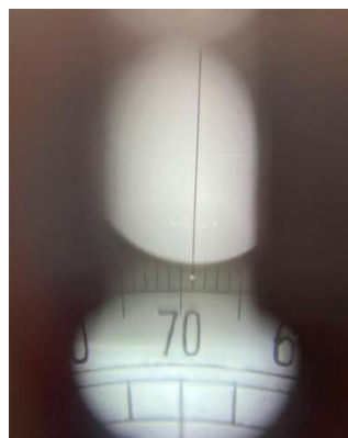
Ablesung über das hochwertige Prisma
