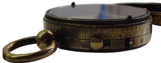
Seitenansicht mit Feststellhebel, Arretierstift und Randskala
