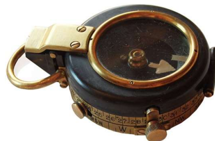
Messinggehäuse mit Skala aussen
