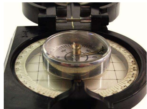
kleiner Taschenkompass auf der transparenten Bodenplatte
