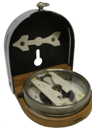
Diopterbussole aus dem Jahre 1905 nachleuchtend durch Balmainflüssigkeit
