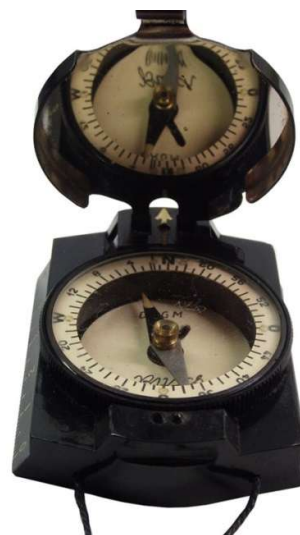
Verwendung eines Spiegels für eine bessere Orientierung
