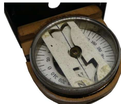
rechtsdrehende Skala in 360 Grad
