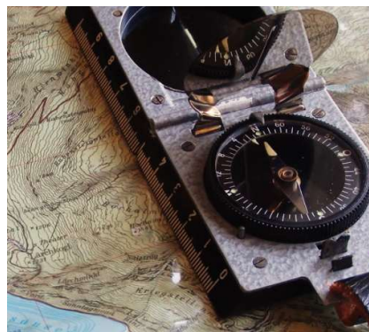
10 cm lange Anlegekante erleichtert die Kompassarbeit mit der Karte
