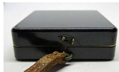
Gehäuse aus Bakelit mit Arretierung
