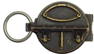
Gehäuseboden Armeemodell mit umklappbarer Anlegkante
