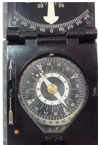
Kompassskala 64-00 Strich linksdrehend
