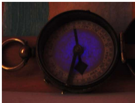
Skala nachleuchtend mit stark herausstechendem Marschrichtungspfeil
