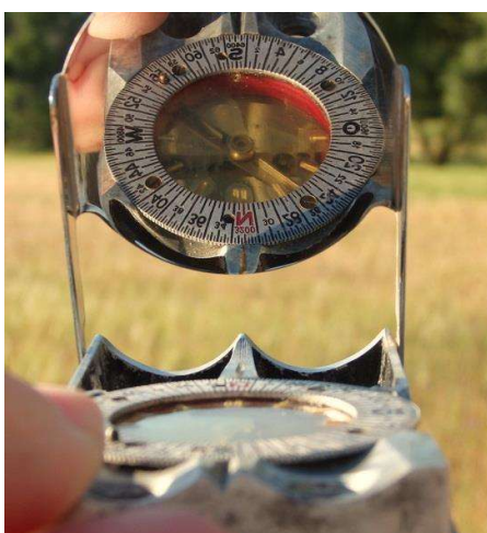
Ablesung an der Nadel über den Spiegel
