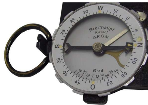
Kompass-Skala 64-00 Strich linksdrehend
