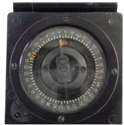
Skala 360 Grad rechtsdrehend
