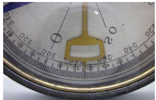
Neigungsmesser in die Skala integriert
