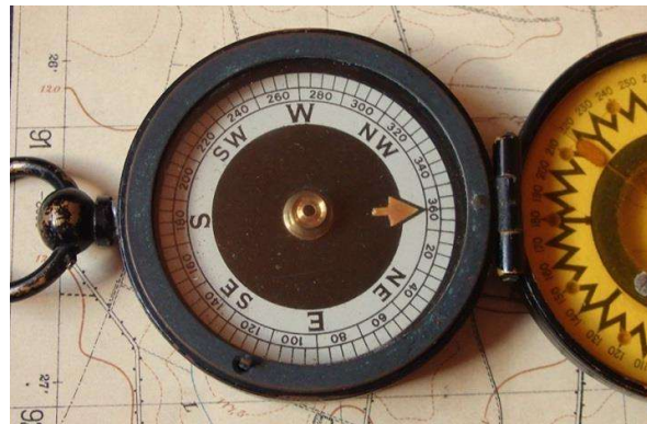
Skala 360 Grad rechtsdrehend
