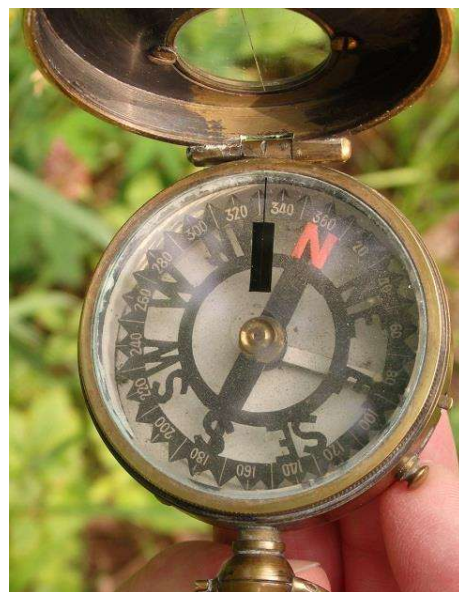
Skala 360 Grad rechtsdrehend „Skeleton Dial“
