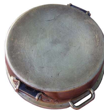
Messingdeckel schützt die Skala
