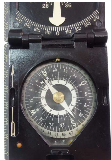
Kompassskala 64-00 Strich linksdrehend
