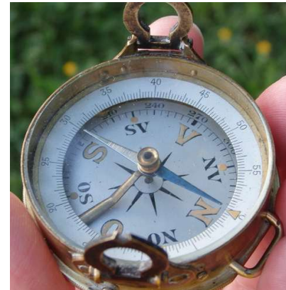
Skala mit Visiereinrichtung
