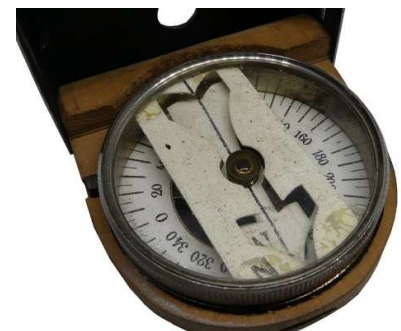
rechtsdrehende Skala in 360 Grad
