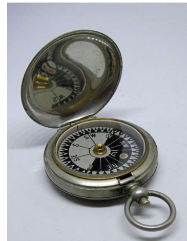
Skala nach Singer Patent mit radioaktiver Markierung
