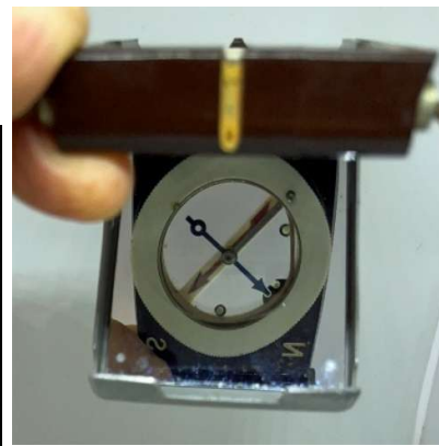
Anvisieren des Zieles und Beobachten der Mangetnadel mit einem Blick möglich
