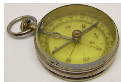
Kartenkompass mit einer Remontoirarretierung
