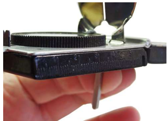
Haltemechanismus des Marschkompasses I Patent 1936 – D.R.P.
