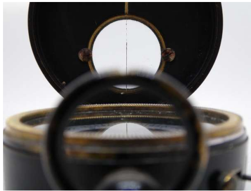
Der Daumenring mit einer Kerbe als Peilhilfe
