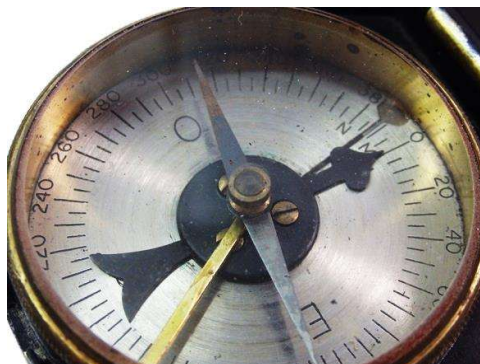
Gaumont Skala Modéle 1922 400 gon Skala
