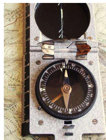
Deklinationsskorrektur manuell angepasst
