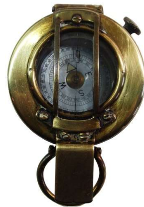
Ablesung bei geschlossenem Deckel
