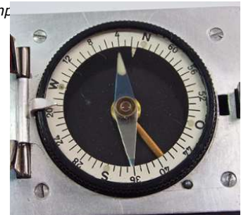
Skala des Touristenkompasses mit Stabilisationsring
