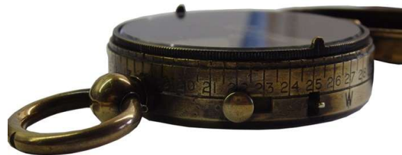
Seitenansicht mit Feststellhebel, Arretierstift und Randskala
