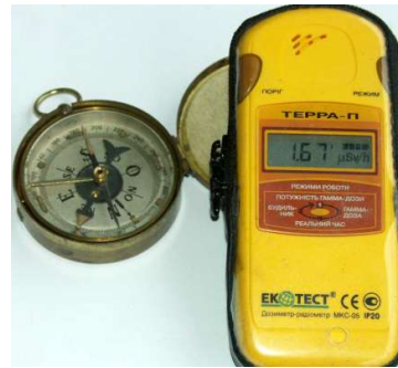
„Boussole Directrice“ aus den 1910er Jahren mit gemessener radioaktiver Strahlung
