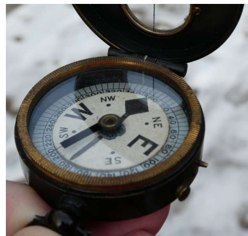
permanente und kurzfristige Arretierung ist seitlich angebracht
