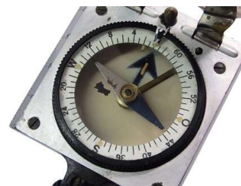
Skala 64-00 Strich linksdrehend mit nachtleuchtendem Marschrichtungspfeil
