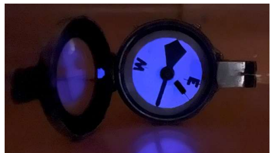
Nachtauglich nach Bestrahlen mit einer hochenergetischen Lampe
