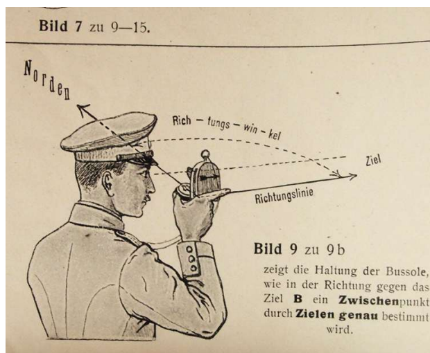
Anschauliche Darstellung des Zielvorganges
