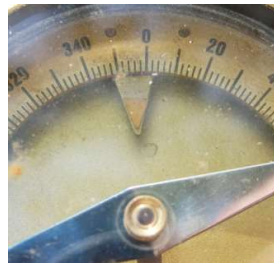
Deklinationskorrektur mit 5 Grad West
