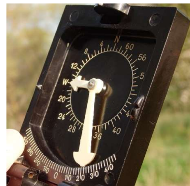
Kippen des Deckels und Ablesen des Steigung
