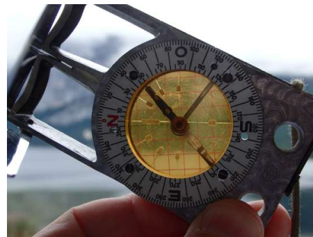
Winterer Bussole bei Messen von Höhenwinkeln
