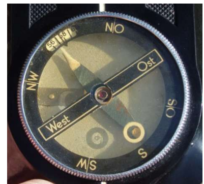
Skala mit Ablesung der Richtung
